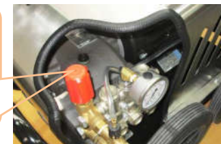
ด้ามปรับแรงดันของน้ำ หมุนตามเข็มนาฬิกาปรับแรงดันน้ำเพิ่ม หมุนตามเข็มนาฬิกาลดแรงดันน้ำ
