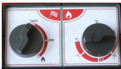
13. สวิตซ์ เปิด-ปิด การทำงานของเครื่อง และ ฟังก์ชันการใช้น้ำร้อน
