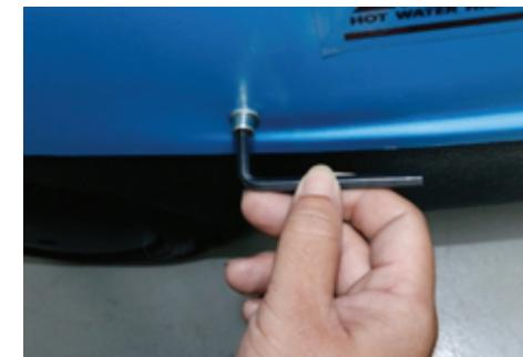
3. ตรวจสอบปั๊ม โดยตรวจสอบระดับน้ำมันเครื่องให้อยู่ในเกณฑ์ที่กำหนด
