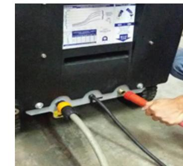
9.นำปืนยารฉีดน้ำแรงดันสูงประกอบกับ สายฉีดน้ำแรงดันสูง แล้วขันล็อคให้แน่น
