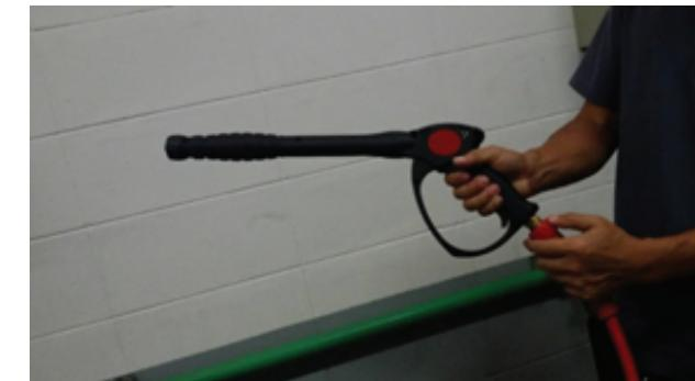
10. นำก้านต่อสแตนเลส ยาว 50 ซม. ต่อเข้ากับปืนยารฉีดน้ำแรงดันสูง แล้วขันล็อคให้แน่น
